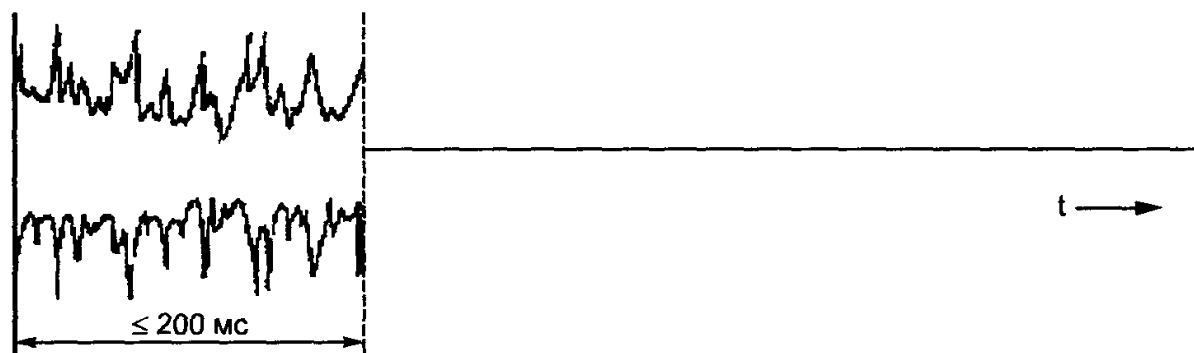
Одна кратковременная ИРП ИРП продолжительностью не более 200 мс, состоящая из непрерывной последовательности импульсов и наблюдаемая на выходе промежуточной частоты (ПЧ) измерителя ИРП
